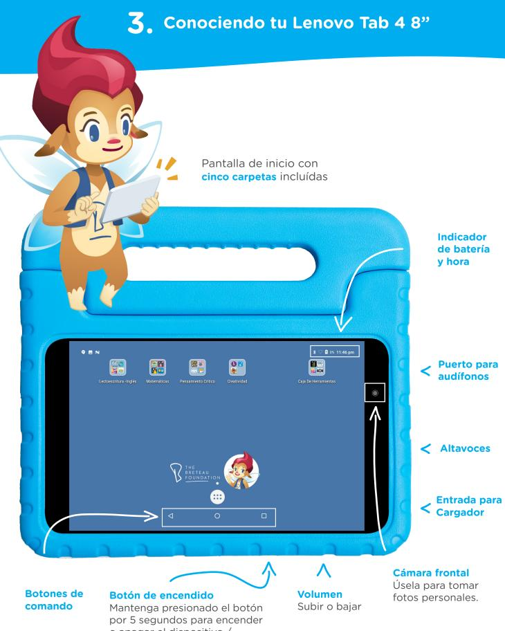
Mantenga presionado el botón por 5 segundos para encender o apagar el dispositivo / presione el botón brevemente para bloquearlo.
